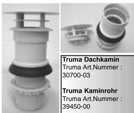
Le conduit de cheminée flexible en acier inoxydable est inséré dans la cheminée de toit ainsi que sur la bouche de la sortie des gaz (A). Il est ensuite fixé avec un collier de serrage à vis tangente ou avec les vis Truma livrées avec la cheminée de toit. L'acheminement des gaz doit être continuellement posé vers le haut.
